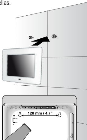
Instalación en la pared
